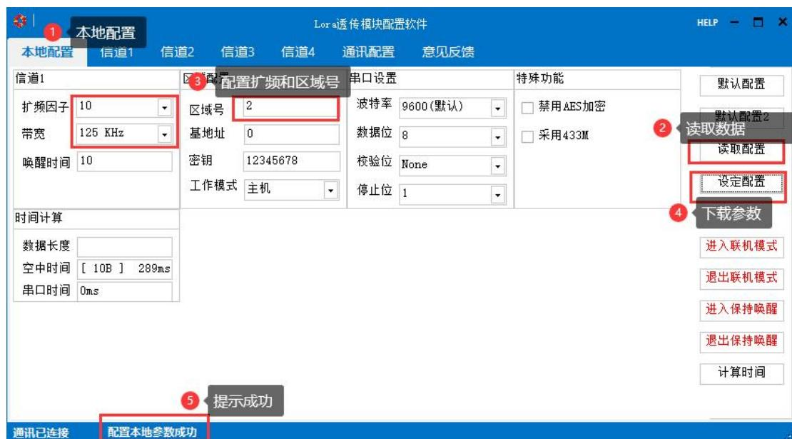
进入自动配置后，其它子机长按按键 3S 点按 1S 会自动搜所配对，成功后提示出更改 LORA 参数成功，可与透传模块、网关、DAM 系列子机配合使用。
