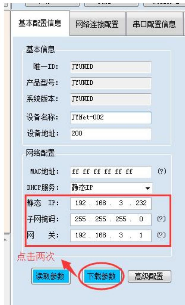
2、当设备能搜索到，修改设备参数，点击“配置参数”无反应时，解决办法：
