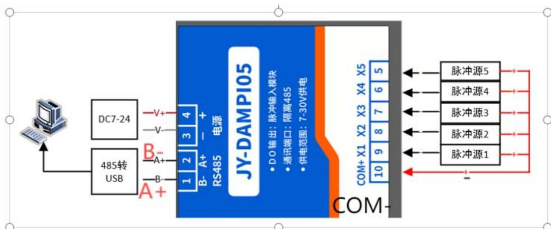
设备电源口支持 7~24V DC 输入, 485 接口负责配置设备参数, COM-为脉冲输入共负端, X1~X5 为脉冲源正信号输入端, 具体接线图如上所示。
