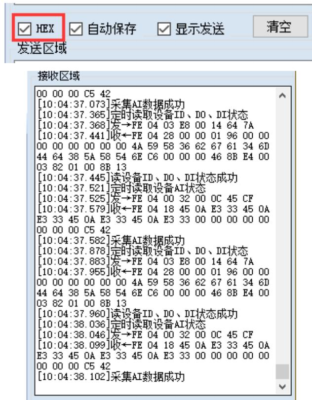
指令生成说明：对于下表中没有的指令，用户可以自己根据 modbus 协议生成，对于继
