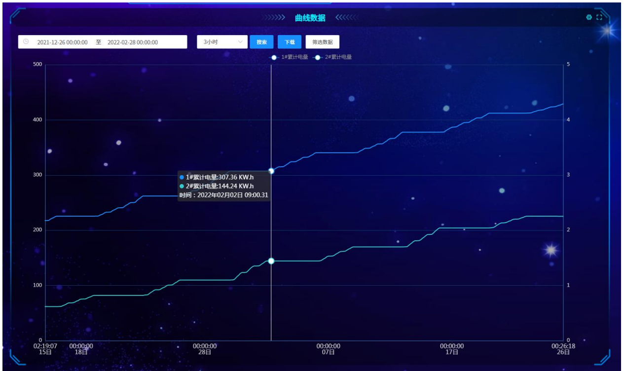
1#、2#泵工作电量曲线
